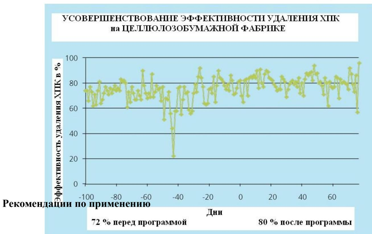
BioRemove 1100 добавляется ежедневно непосредственно в аэротенк. Микроорганизмы в BioRemove 1100 функционируют в диапазоне pH 6.0-9.0, с оптимальной около 7,0. Температура сточных вод влияет на активность, с приблизительным удвоением максимальной скорости роста на каждые 10 ° C, с повышением температуры до (приблизительно) верхнего предела 40 ° C . Очень низкая активность ожидается ниже 5 ° C .
